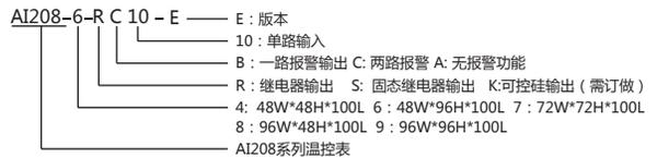
注意：选择加热冷却控制方式时，如还需报警功能，请选择带两路报警的型号。
