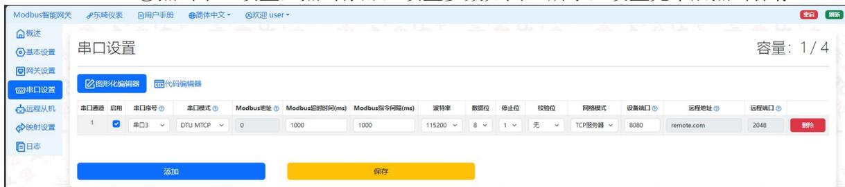
图 27 DTU MTCP模式串口设置
