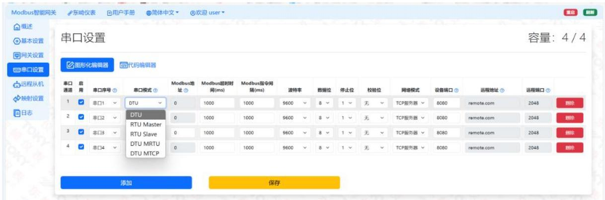
图 11 串口参数配置
