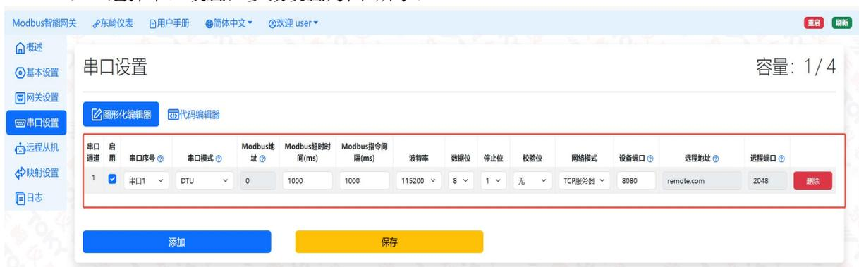
图 6 DTU透传模式串口设置
