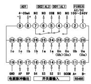
注:①电压输入接线端子,括号内标号表示三相三线接法;接线如有变动,请以出厂仪表接线为准.②电流"\*"为电流进线端,所有进线出线必须统一,否则引起测量不准.
