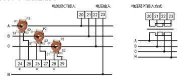
方式2(2个CT):三相三线的接线方式 (只针对电能计量场合)
