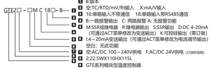
注: 选型时应注明输入信号类型: 第一种: TC/RTD/mV/Rt; 第二种: mA/V。
