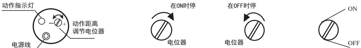
a. 电位器顺时针旋转时, 检测距离增大, 逆时针旋转时则变小, 调节转数10圈。
