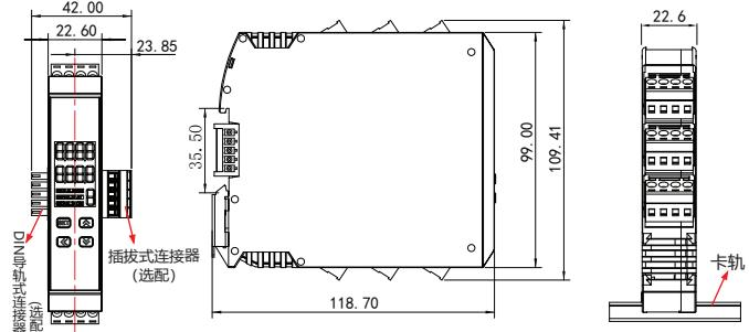
注：35mm 标准卡轨出厂不配，产品使用必须固定在卡轨上。
