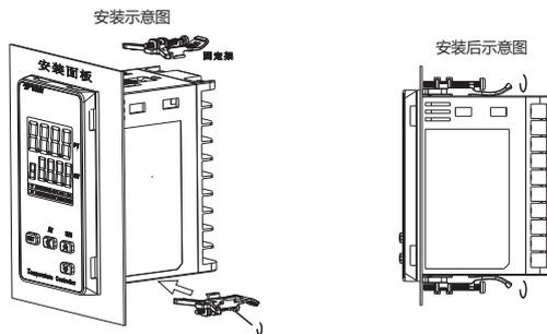
● 安装方法: 需要先将仪表嵌入预先开好的安装孔中, 然后把固定支架放置于仪表外壳的安装槽上, 将支架往面板方向推动直至卡紧仪表 (操作如安装示意图)。如果不够紧, 可将固定螺丝锁紧。
