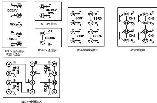
2、部分接线图实例
