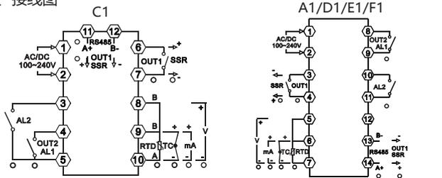
注：实际接线图中，实心圆点表示有此功能，空心圆点表示无此功能。出厂时会根据实际功能标注实心或空心圆点。
